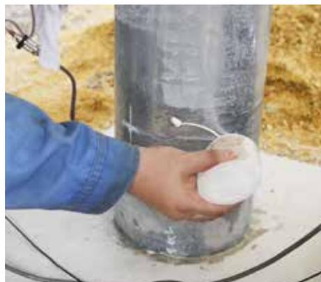
センサーと鋼管の密着性を高めるジェルを塗布します。
