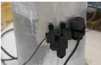
自走式超音波センサーが鋼管に取付き、全周をスクリーニングします。
