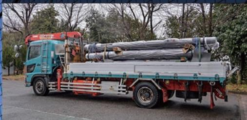
最大15mの施工高さでも分割されたポールは1本あたり2.7m～6.5mの長さなのでコンパクトに運送できます。
