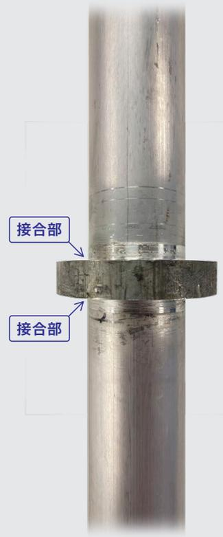
アルミ材摩擦圧接の接合部
