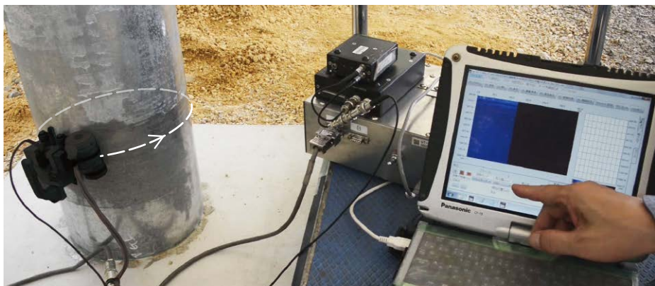
端末操作により自走式センサーを始動、鋼管の全周スクリーニングを開始します。
