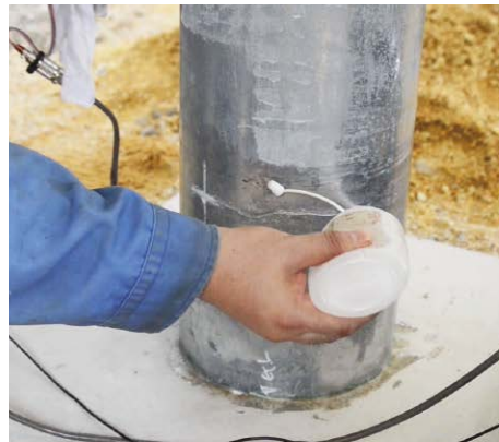
センサーと鋼管の密着性を高めるジェルを塗布します。
