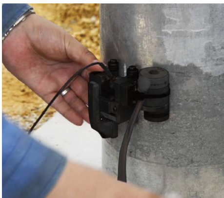
自走式センサー鋼管へ取り付けます（磁石式）。
